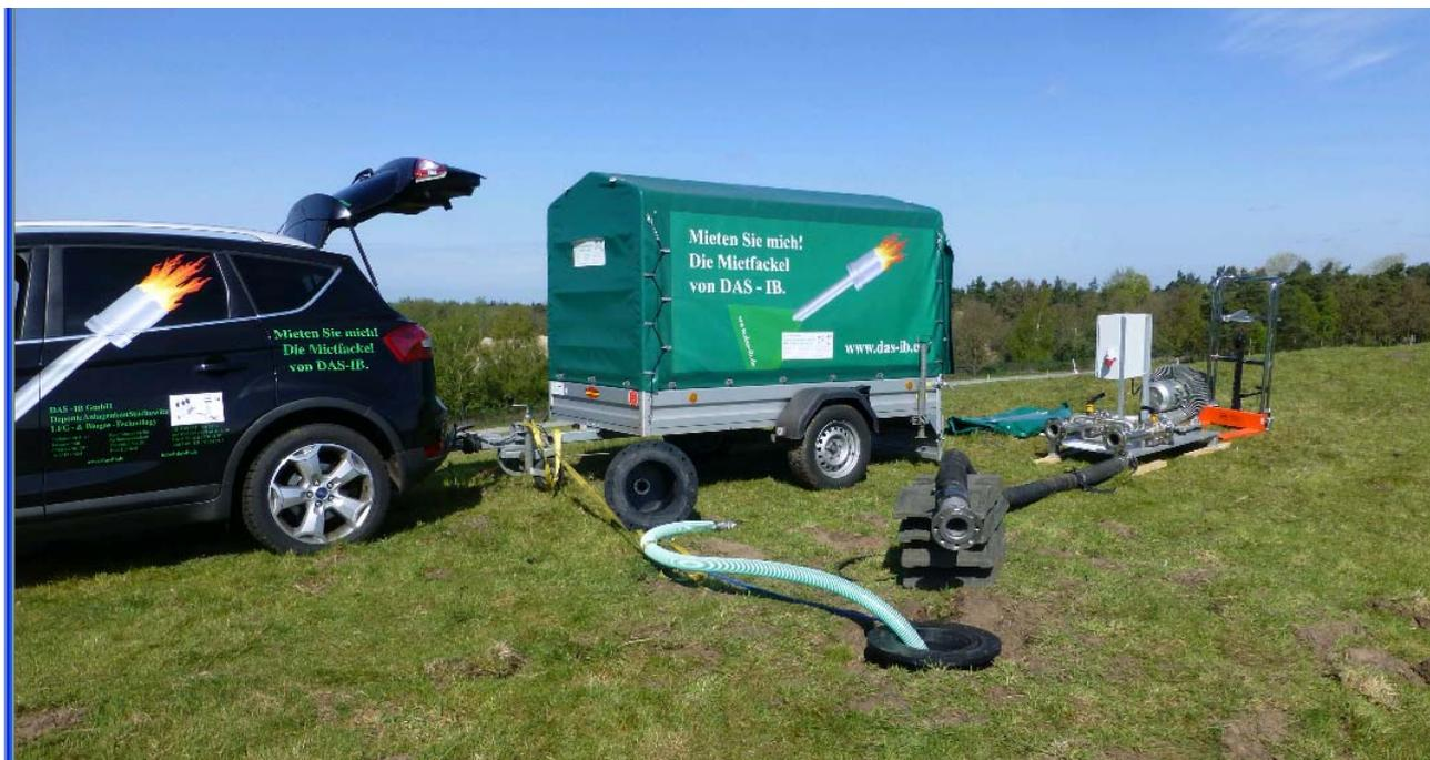
Abbildungen 3, Einsatz der mobilen Kleinstfackel DMF V mit mobiler Gasanalyse und Durchflußmessung auf dem Standort in Vechta - Tonnenmoor [DAS - IB GmbH] als Ersatz für die ursprüngliche Gasentsorgung in der Ziegelei sowie theoretische und praktische Lufteinblasung (Bild oben rechts und unten)
