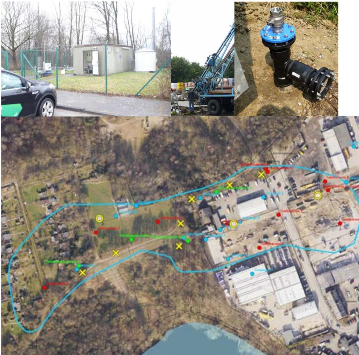
Abbildung 6: OBEN: Maschinenteknik der Altablagerung „Kiel - Drachensee“ (li) sowie Ausführung von Bohrarbeiten im Industriegebiet der Altablagerung (Mi) und re: neuer Belüftungsbrunnen
